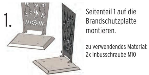
1. Seitenteil 1 auf die Brandschutzplatte montieren.
