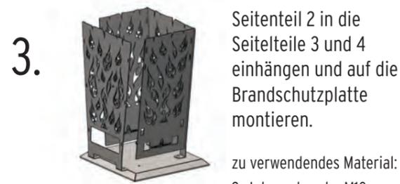
3. Seitenteil 2 in die Seitenteile 3 und 4 einhängen und auf die Brandschutzplatte montieren.
