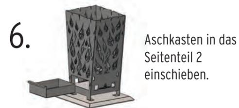
6. Aschkasten in das Seitenteil 2 einschieben.
